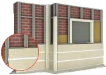
Fugali kaplama sistemi
